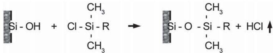
Abbildung 2.1: Beispiel für eine Reaktion von gebundenem Chlorsilan an einer Siliciumdioxidpartikeloberfläche [75]
