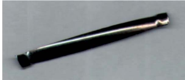
**Abbildung 6 Gefräste Stahlfaser (Foto: KrampeHarex)**
