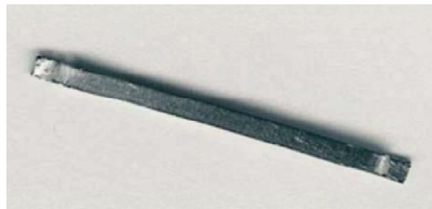
Abbildung 7 Kaltbandfasern mit Endverhakung (Foto: Krampeharex)
