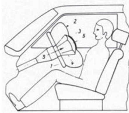
Abbildung 2.5: Skizze der Aufprallschutzvorrichtung für den Insassen eines Kraftfahrzeugs von Mercedes-Benz [Mer91]
