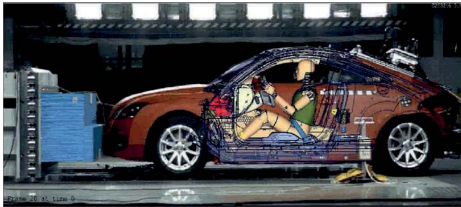
Abbildung 1.2: Teilüberdeckter Frontcrash gegen eine deformierbare Barriere inklusive überlagerter Struktur- und Insassensimulation
