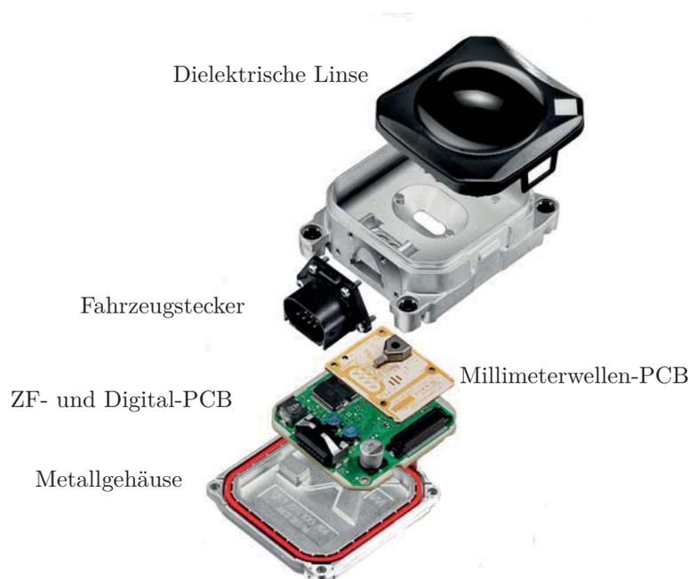
Abb. 1.4: Detaildarstellung eines aktuellen kommerziellen Radarsensors (Fa. Bosch, nach [18])
