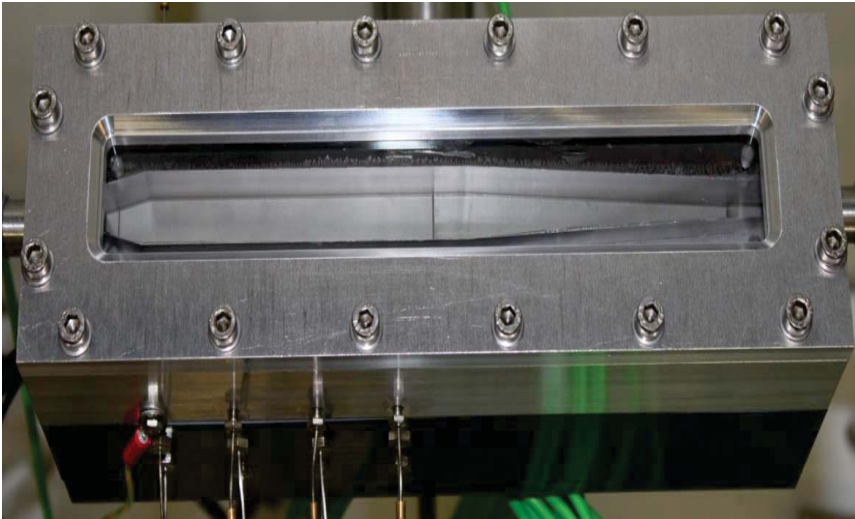
Abb. 4.18: Strömungskanal zur Generierung von Biofilmen
