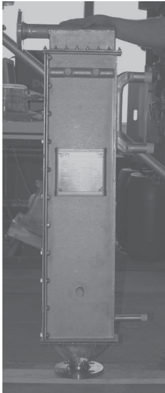
Abb. 4.5: Kissenplattenverdampfer stehend im nicht eingebauten Zustand
