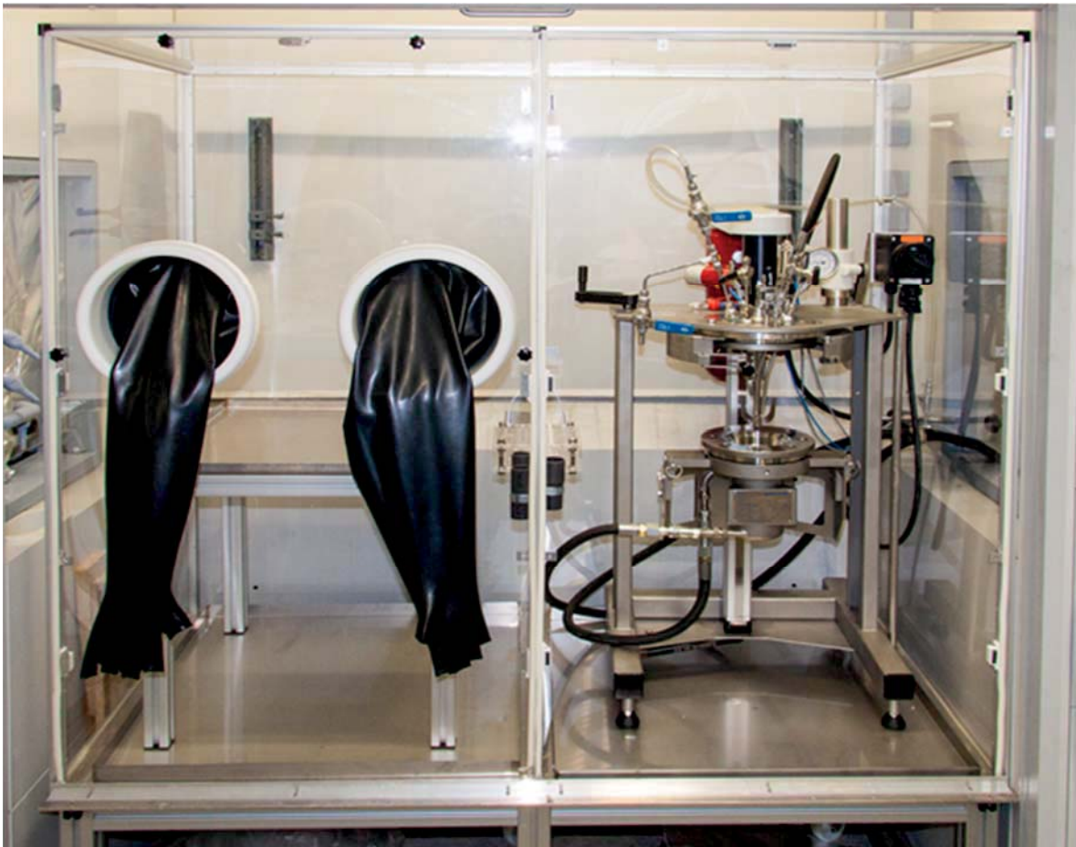
Abb. 4.26.a: Einhausung für Arbeiten in Inertgas
