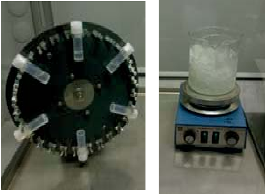
Abb. 4.52: Extraktionslaborgeräte; links Rotationsmischer mit 2,5 mL Versuchsgefäßen, rechts Becherglas mit Eismantel
